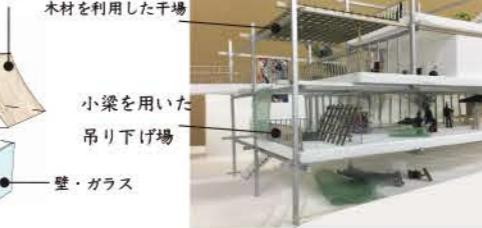
6900×6900mm のメインフレームにより機能性を持った構造と建築の一連のリズムを作る。
