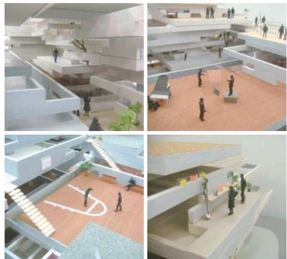
**講評** 物と建物の間の隙間を「意味ある隙間」として再構成するため、建物外壁を高さ700mmごとにずらして再積層するデザイン手法を展開し、密集街区に相応しいスケール感と賑わいを創出しようとする街区再生提案である。あえて既存外壁を再利用することによって、都市の文脈や時間軸を継承するという姿勢を示しており、古い街並みを簡単に壊し経済効率優先の高層建築を建てる再開発に真向から異を唱えている。建築デザインによって魅力的な都市を再構築することができるんだという、建築の可能性を示唆している点が高く評価された。
